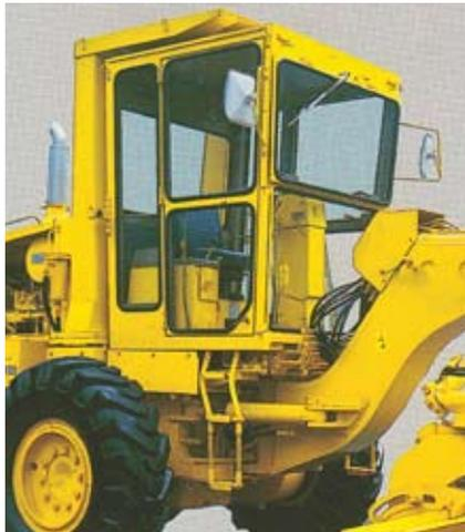
**Козырек защиты от опрокидывания и кабина** соответствуют стандартам ISO3471 и SAEJ1040a ROPS. В комплект входят привязной ремень, зеркало заднего вида, внутреннее зеркало, дворники и стеклоомыватель.
