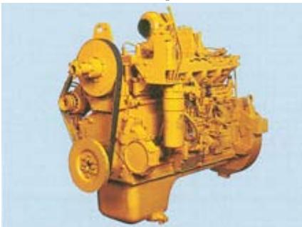
Мощная и надежная силовая установка. Хорошо зарекомендовавший себя в эксплуатации и экономичный по топливу двигатель Komatsu S6D125 с прямым впрыском топлива хорошо работает на предельной нагрузке при выполнении тяжелых работ. Его номинальные характеристики выдерживаются вплоть до высоты 3000 м (9840 футов) без необходимости регулировки подачи топлива.
