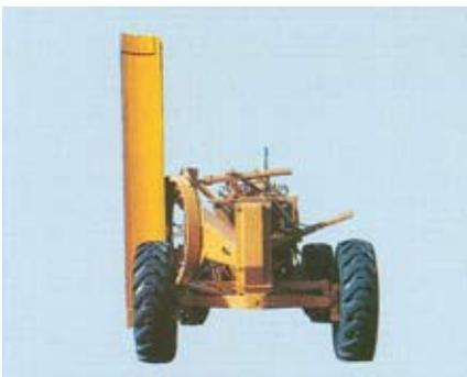
Возможность подрезки насыпи под углом  $90^\circ$  достигается за счет того, что приводимый в действие гидравлической системой отвал может устанавливаться под прямым углом с любой стороны. Нужный угол захвата может устанавливаться оператором из кабины. Это ускоряет и облегчает работу оператора и увеличивает производительность его труда.
