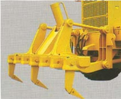
**Стойки рыхлителя:** четыре штуки, параллельные, установлены сзади. Подъем и опускание осуществляются гидравлическим способом. Рыхлитель может использоваться для выворачивания камней или разрыхления плотного грунта, с которым не может работать кирковщик.
