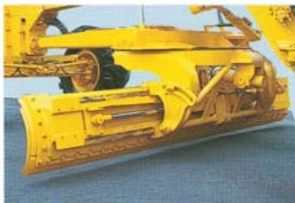
Управление поворотом отвала и его наклоном производится с помощью гидравлической системы: облегчает часто повторяемые выдвигания отвала. Большой поворот отвала значительно упрощает ведение работ по резанию и выравниванию грунта на больших площадях. Поскольку наличие гидроцилиндра управления отвалом позволяет регулировать угол захвата, то возможность достижения высокой производительности машины на земляных работах будет больше зависеть от характера перемещаемого грунта.
