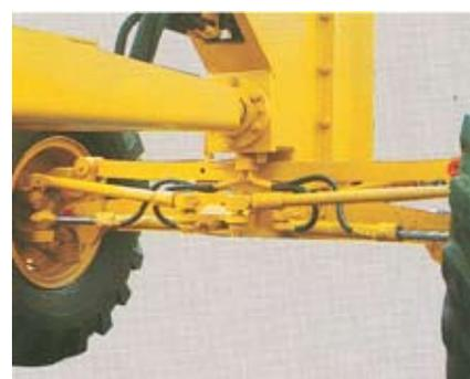
**Гидравлическая рулевая система с переключением под нагрузкой** относится к типу систем с полноповоротным клапаном. Рулевая сошка приводится в действие двумя гидроцилиндрами напрямую. Такая система позволяет значительно снизить нагрузку на оператора, и он меньше устает при работе.
