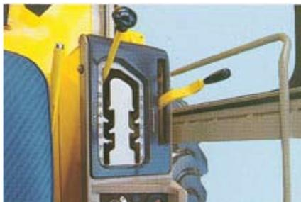
Мощная фирменная коробка передач HYDROSHIFT с возможностью переключения передач под нагрузкой не нуждается в гидротрансформаторе, обеспечивает эффективную передачу мощности, достаточную тягу и постоянную рабочую скорость вне зависимости от действующей нагрузки на отвал.
